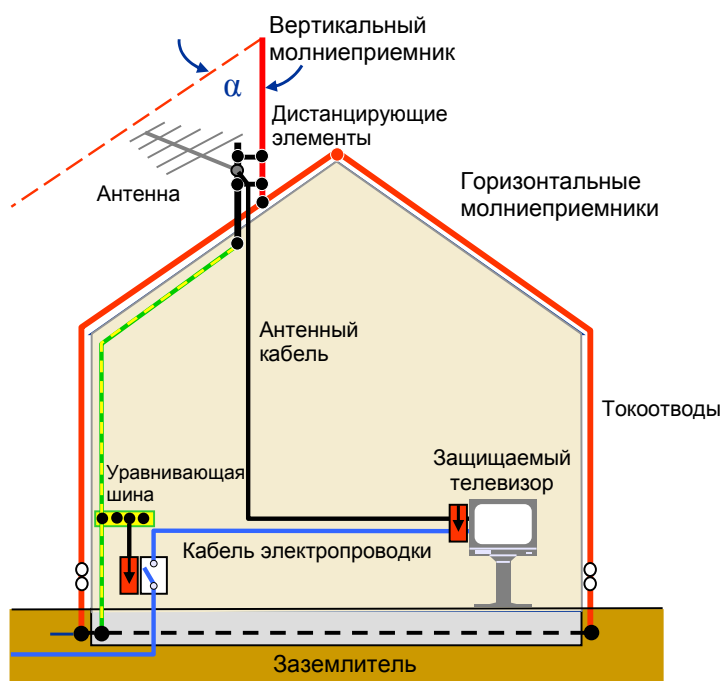
Рис. 22. Защита мачты и антенны от прямого удара молнии [ ]
